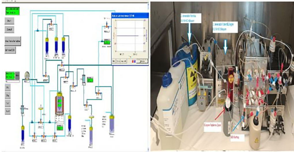
Şekil 1. Galyum-68 radyofarmasötik üretim sistemi
