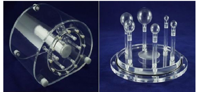
Şekil 3. PET görüntü kalitesi fantomu. İçlerine sıvı radyonüklit doldurulabilen kürelerin iç aktif çapları sırasıyla: 10 mm, 13 mm, 17 mm, 22 mm, 28 mm ve 37 mm'dir. Fantomunun toplam hacmi 9,7 litredir
