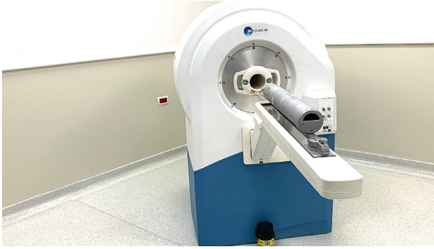
Şekil 3. MR Solutions- Klinik öncesi, cryogen-free 7T MRG ve entegre µPET insert sistemi (16) MRG: Manyetik rezonans görüntüleme, µPET: Mikro-pozitron emisyon tomografi
