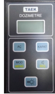
Resim 1. Ölçümde kullanılan Geiger-Müller cihazı
