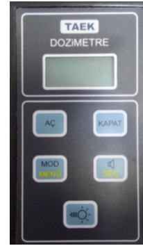
Resim 1. Ölçümde kullanılan Geiger-Müller cihazı
