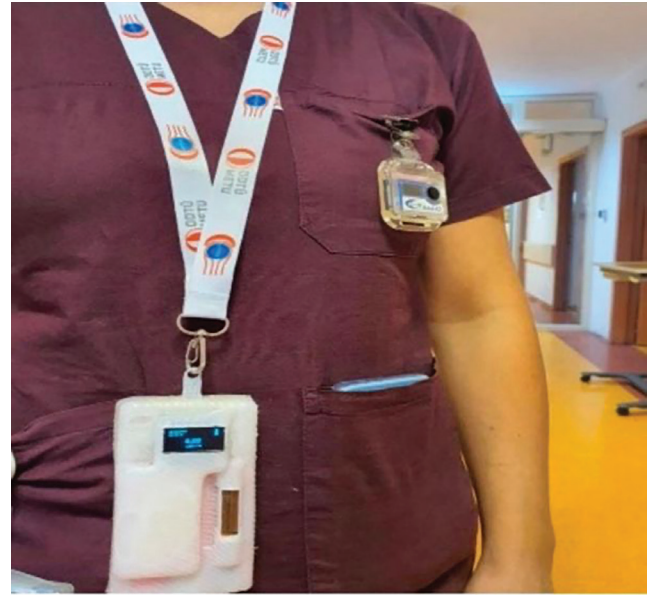
Şekil 2. İvmeRad'ın sahada kullanım tasarımı (TLD yaka dozimetre ile birlikte)
