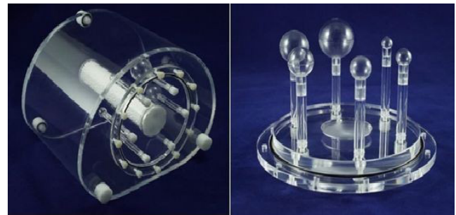
Şekil 3. PET görüntü kalitesi fantomu. İçlerine sıvı radyonüklit doldurulabilen kürelerin iç aktif çapları sırasıyla: 10 mm, 13 mm, 17 mm, 22 mm, 28 mm ve 37 mm'dir. Fantomun toplam hacmi 9,7 litredir
